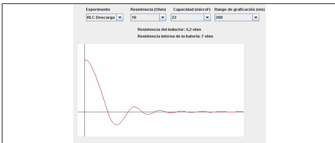
Oscilación electromagnética de un circuito RLC sin alimentación con laboratorio remoto
