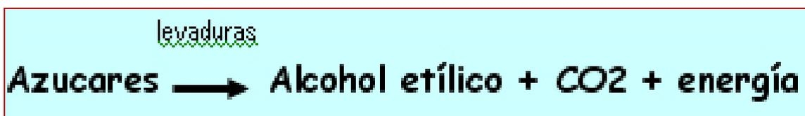
Una vez ajustada la dosis de correctores al mosto, realizamos una **SIEMBRA DE LEVADURAS SELECCIONADAS**. Las dosis normales es de 20-25 gr/Hl de levaduras seleccionadas, en un mosto y se alcanza un mínimo de  $5 \times 10^6$  de células viables/ ml.
