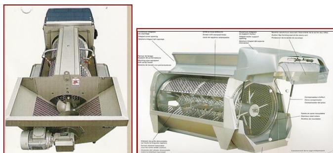
El sistema mecánico para obtener el **MOSTO FLOR**, se consigue a través de una **ESTRUJADORA DE RODILLOS DE CAUCHO**, ubicada debajo de la **DESCOBAJADORA**, que presionará el grano lo justo como para desprender el mosto o jugo, y evitar que pepitas y raspones o escobajos (soporte estructural del racimo) se rompan y contaminen el mosto.
