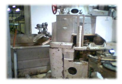
**ESTERILIZACIÓN:** luego del remachado las latas entran en una cinta metálica con dos desviaciones hacia un tanque de agua, en el cual se encuentran 2 canastos metálicos móviles mediante pequeñas ruedas. Estos canastos son los que transportan a los tarros hacia los 3 autoclaves, mediante pequeñas grúas guiadas a través de un sistema eléctrico de guinches.
