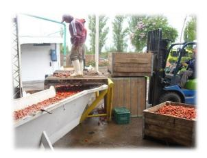
En esta parte de la operación el tomate debido a su caída y la presión de los picos aspersores, genera turbulencia en la cuba, por lo tanto se termina de eliminar la suciedad.
