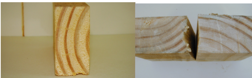
Fotografía 4: Desaparición de las rajaduras después de un cepillado de 5 mm
