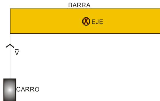
**Figura 1** – Dispositivo para calcular el momento cinético de la barra
