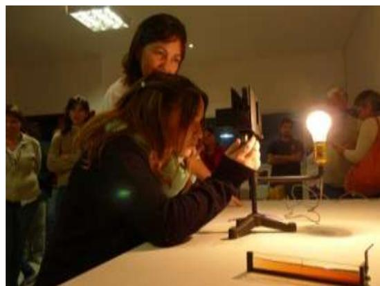
**Figura 4. Medición de color de diferentes mieles con colorímetro Pfund**
