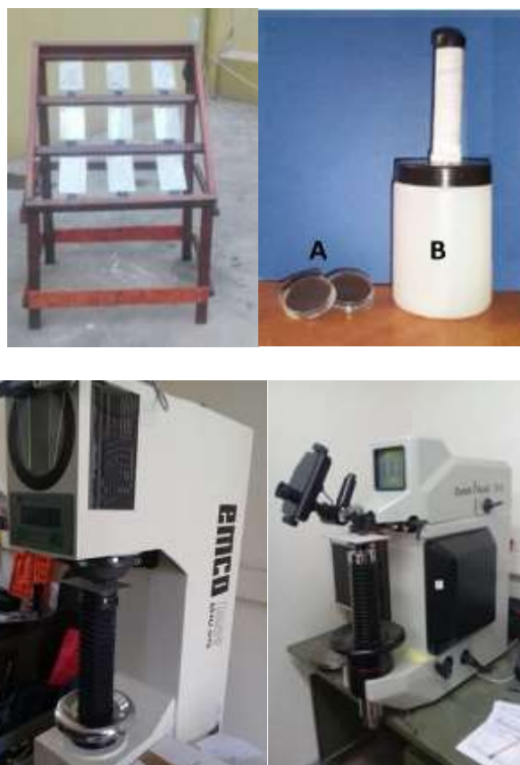
Figura 2. Vistas superior, corresponden a los soporte de las probetas de control y captadores de contaminantes, En la inferior, el equipo de la izquierda corresponde al durómetro EMCOTEST, modelo M4U 075. El del lado derecho es un durómetro Zwick, modelo Roell ZHU del año 2012. Trabaja con potencia: 114/230 V, 2/1A y 50/60 Hz, 1L/N/Pe.
