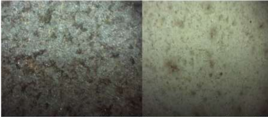
Placa expuesta en Antofagasta- Acero A36, se observa un ataque mas parejo, mas uniforme en toda la placa.
