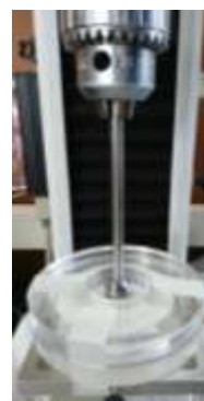
Figura 1. Soportes de acrílico y punta de medición para la realización del ensayo de extensibilidad.
