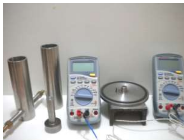
Figura 3. Accesorios y equipamiento desarrollado para la medición de la difusividad térmica.
