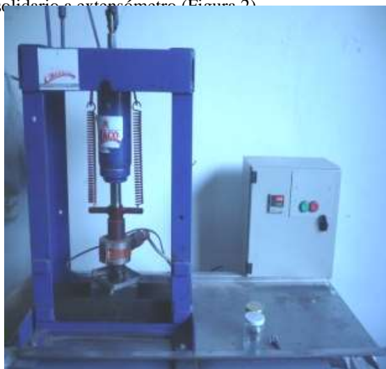
Figura 2. Equipamiento empleado para la extracción mecánica convencional
