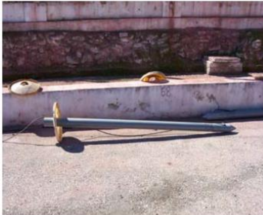
Figura 18.- Columna para la aireación
