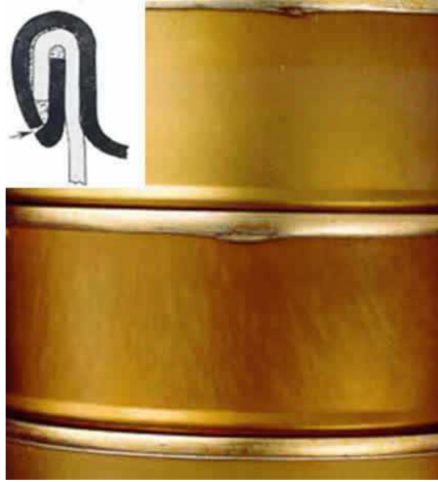
Figura 16. Defectos apreciables visualmente: Cierre roto. (Canadian Food Inspection Agency)
