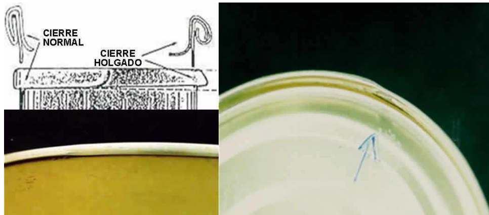
Figura 14. Defectos apreciables visualmente: Spinner. (Canadian Food Inspection Agency)
