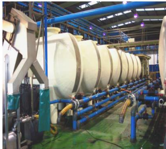
Figura 23.- Depósitos de oxidación de fibra de vidrio
